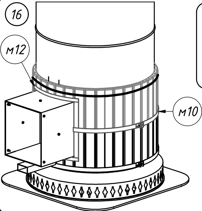
По мере сборки, эластичный жгут необходимо передвигать вверх для установки следующего ряда плиток облицовки, предварительно зафиксировав предыдущий ряд при помощи хомутов. Замки хомутов рекомендуется располагать друг над другом.
