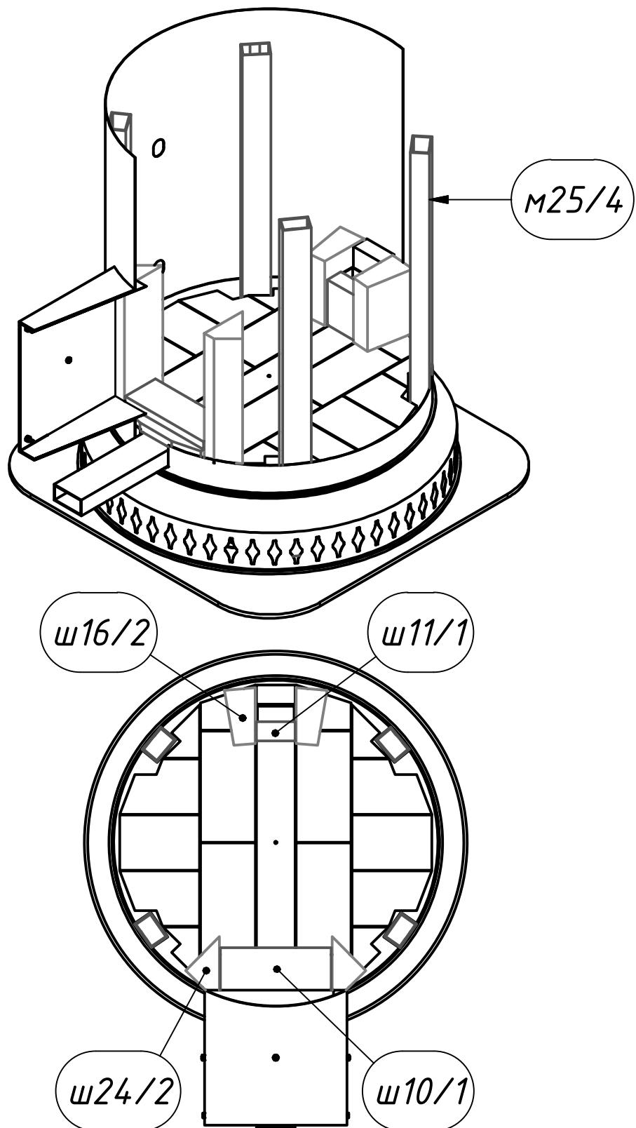
После установки всех элементов, обозначенных на данном шаге, заполнить зазоры между воздушными каналами, кирпичами и кожухом смесью из комплекта с обрезками супервул.
