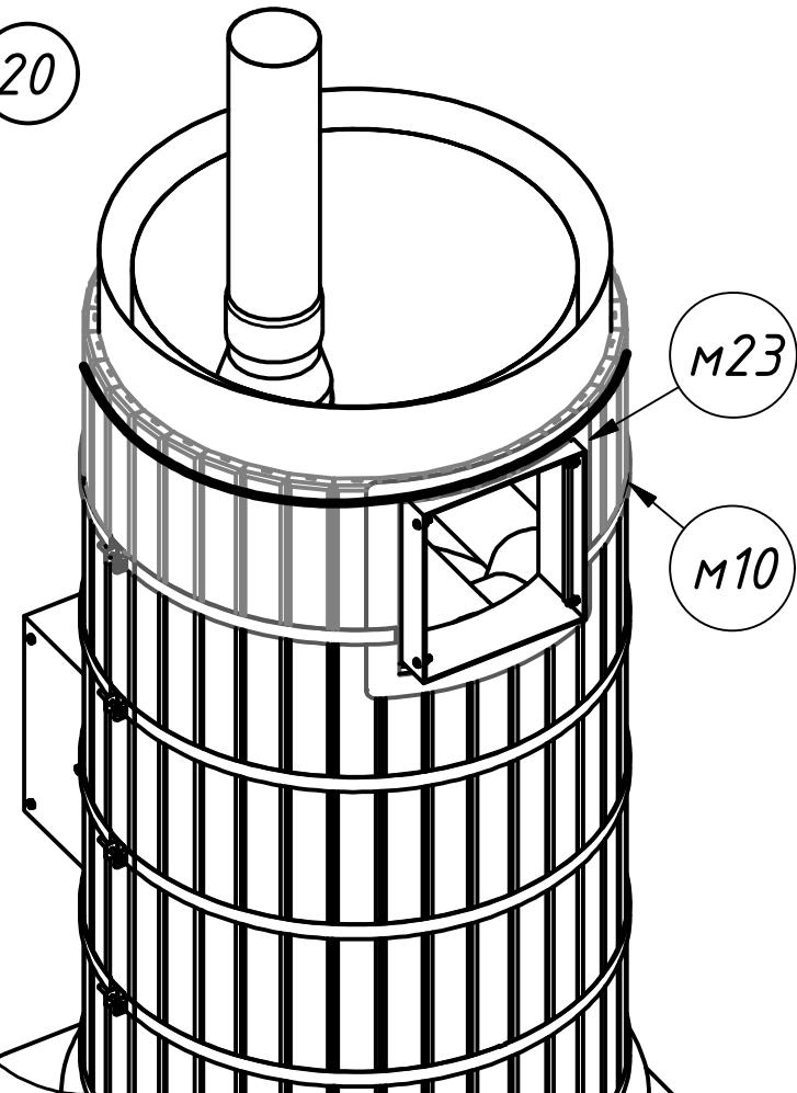
Для облегчения установки элементов облицовки, расположенных вблизи тоннеля каменки, рекомендуется сначала накинуть на тоннель печи рамку м23 с хомутом м10, тугого его не затягивая, и, при размещении плитки, следить за тем, чтобы рамка м23 могла свободно проходить между плитками и плотно прилегать к корпусу печи. Далее можно плотно затянуть хомуты.
