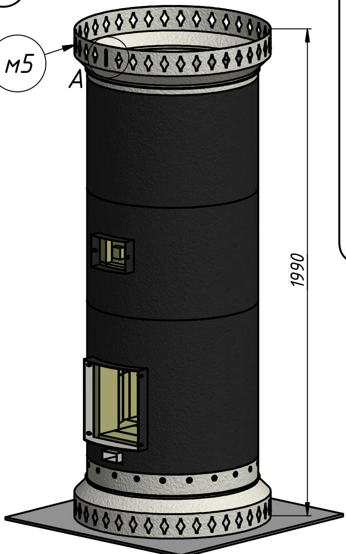
Верхнюю корону м5 расположить таким образом, чтобы овальный вырез под шток шибера был направлен в нужную Вам сторону. (не обязательно так, как на схеме) Временно установите деталь м16 как на листе 19 и проверьте, помещается ли шибер м18 в верхнее фигурное обрамление м5 в выбранном положении. Если нет – поверните деталь м5 таким образом, чтобы все детали помещались на свои места.
