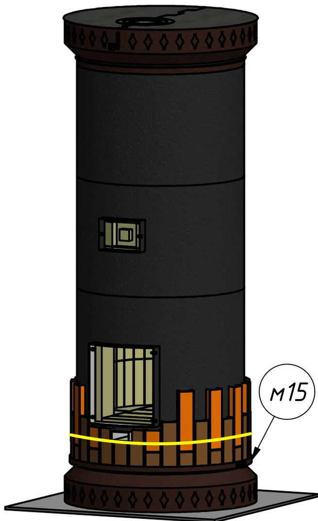
Далее собирается облицовка из плиток по рядам снизу вверх. Для начала работы на печь необходимо надеть эластичный жгут из комплекта. Затем, пользуясь схемой расположения элементов облицовки (см. стр. 21), расположить плитки первого ряда облицовки вокруг корпуса печи, подсовывая их под жгут. Первый ряд облицовки фиксируется нижним 2-образным хомутом М15. Замок хомута рекомендуется располагать в "теневой" зоне.
