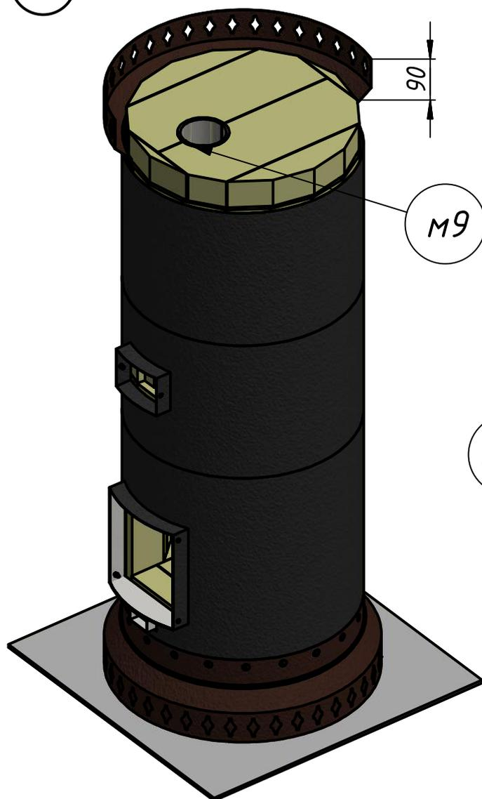
Угловой зазор между шамотом и деталью М5 проложить обрезками супервула и замазать раствором заподлицо с верхом шамота.
