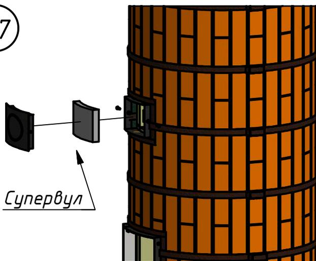
После сборки облицовки внутрь тоннеля прочистной дверки плотно вставить вырезанный с припуском прямоугольник из супервула, после чего установить заглушку чистки и закрепить ее болтами K1 – 2 шт.
