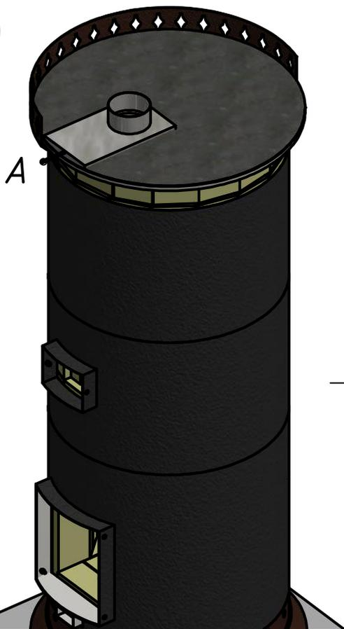
Далее следует примерить и отметить необходимую длину штока шибера м18. Шток должен выступать из верхнего фигурного обрамления корпуса м5 на 30...50мм в закрытом состоянии.
