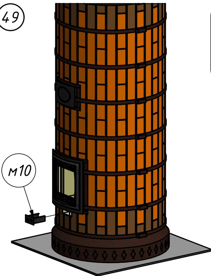
В заключение, установить на место регулятор притока м10 и, при необходимости, увеличить отверстие под дымоход в верхней крышке м6 до нужного диаметра.
