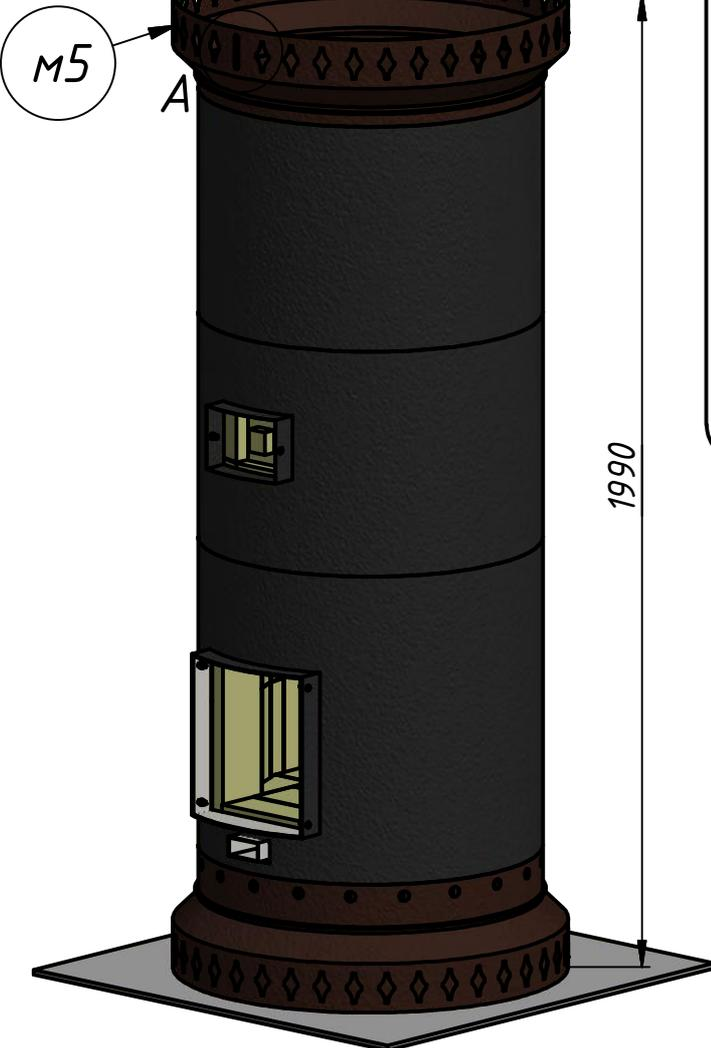
Верхнюю корону м5 расположить таким образом, чтобы овальный вырез под шток шибера был направлен в нужную Вам сторону. (не обязательно так, как на схеме) Временно установите деталь м16 как на листе 19 и проверьте, помещается ли шибер м18 в верхнее фигурное обрамление м5 в выбранном положении. Если нет - поверните деталь м5 таким образом, чтобы все детали помещались на свои места.
