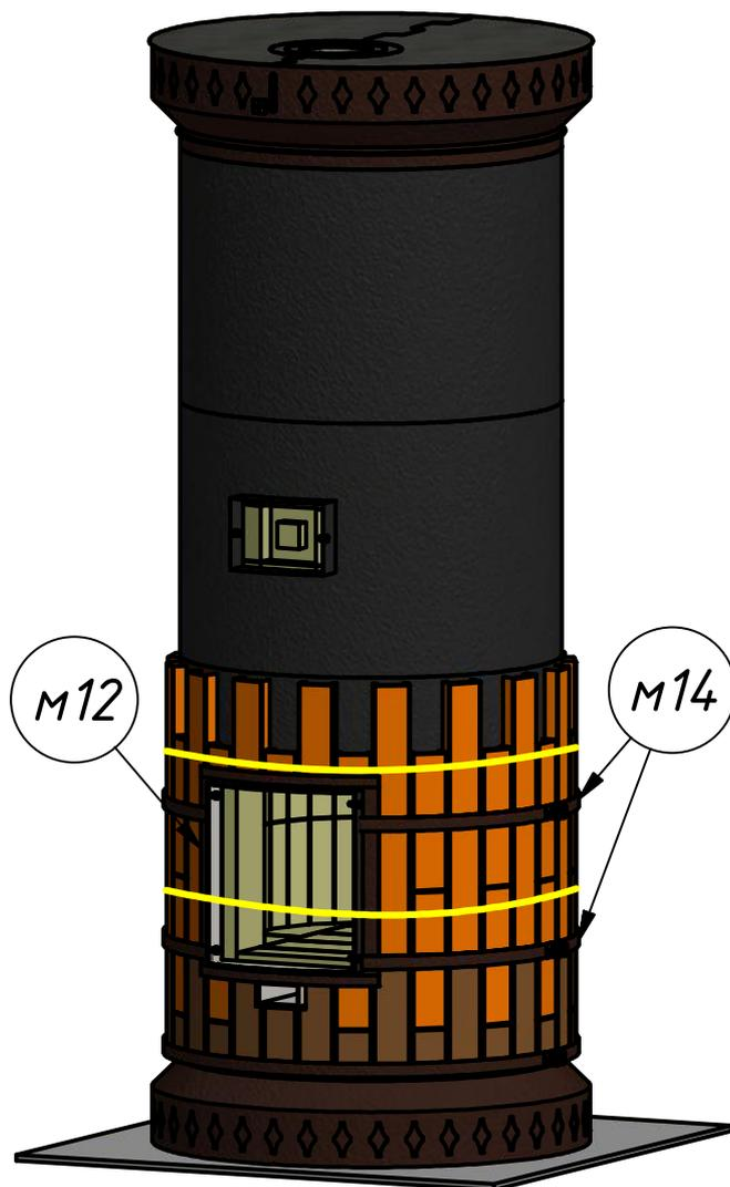
По мере сборки, эластичные жгуты необходимо передвигать вверх для установки следующего ряда плиток облицовки, предварительно зафиксировав предыдущий ряд при помощи хомутов. Замки хомутов рекомендуется располагать друг над другом. На данном шаге следует насадить рамку М12 вместе с двумя хомутами М14, сильно не затягивая их, чтобы иметь возможность подкладывать плитки облицовки под хомуты.
