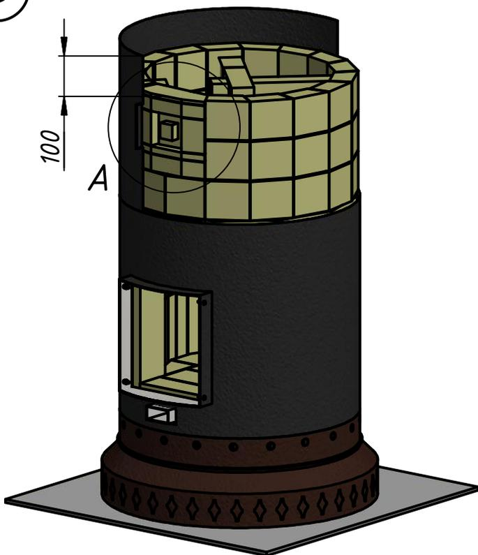
Детали чистки расположить таким образом, чтобы съёмный элемент №27 оказался напротив прочистного отверстия кожуха. (Меняя местами детали 23-26 + сыграть на швах.) Деталь ш27 поставить насухо, а щели замазать раствором.
