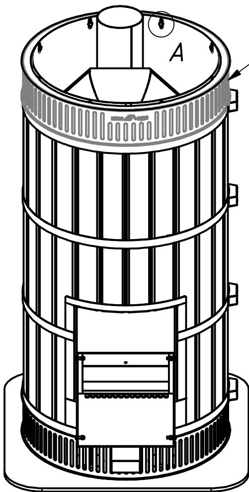
Ушки верхней фигурной окантовки м5 отогнуть вверх, как показано на схеме, затем закрепить данную деталь на корпусе печи при помощи болтов к2 (8 шт.).
