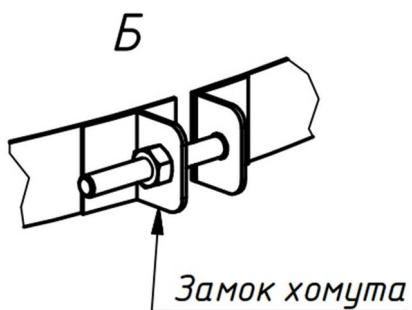
*При размещении хомутов следить за тем, чтобы уголки-фиксаторы, расположенные на них, проходили между плитками облицовки и не препятствовали их размещению!*
