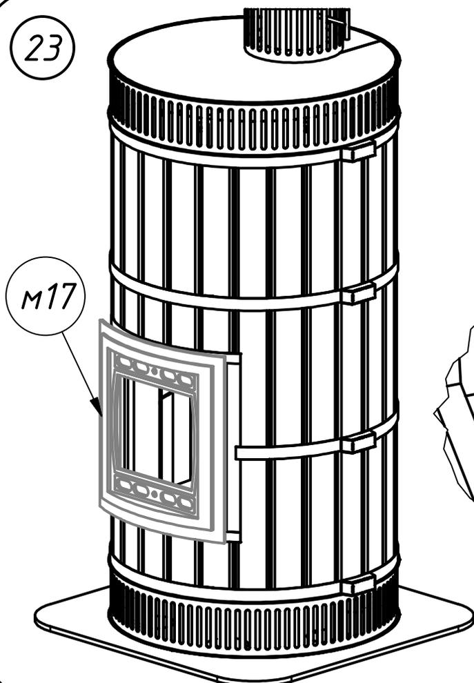
Установить топочную дверку м17 и закрепить её при помощи болтов к2 - 4 шт. и гаек к3 - 4 шт.
