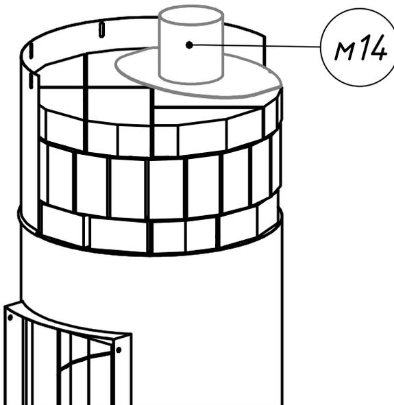
Установить патрубок выходной м14. Отметки на патрубке должны совпадать с отверстиями в верхнем корпусе.
