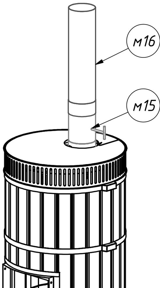
Установить заслонку м15, развернув ручку в удобную сторону, затем установить трубу м16.
