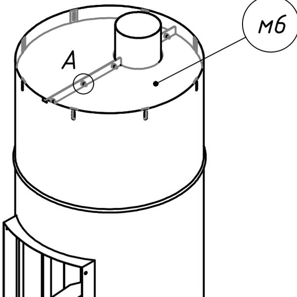
Установить крышку м6 в сборе, совмещая отверстия в ушках крышки с отверстиями в корпусе. Детали крышки должны быть плотно соединены между собой, как показано на схеме.
