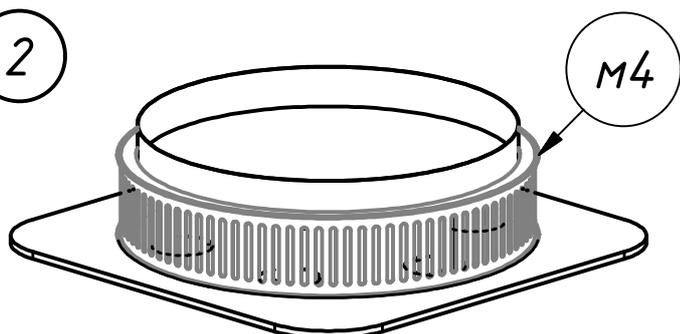
Поверх установленных деталей разместить нижнее фигурное обрамление м4
