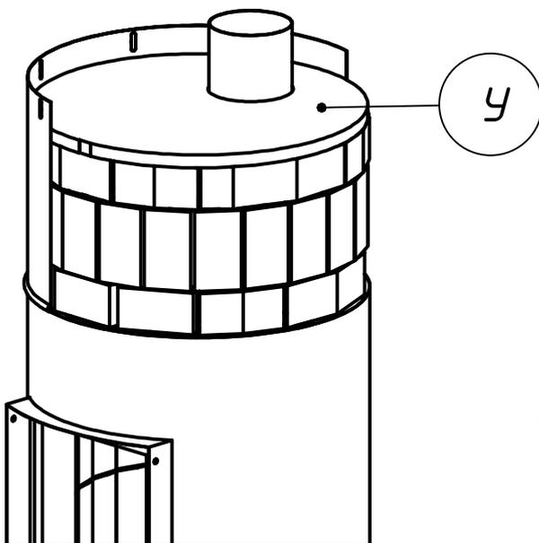
Вырезать из листа супервула толщиной 25 мм уплотнение У. Это удобно сделать, используя в качестве шаблона перевернутую крышку м6. Плотнo уложить уплотнение на шмот внутрь детали м3.
