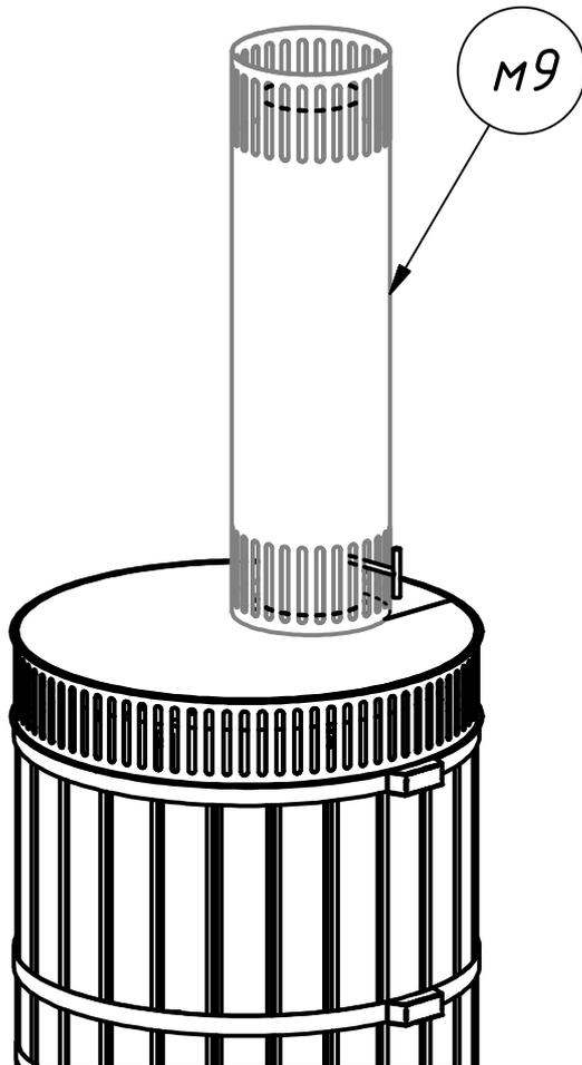
Установить кожух дымохода м9, продев ручку заслонки сквозь одно из отверстий на кожухе, затем скрепить между собой стороны кожуха при помощи болтов к2 (4 шт.)
