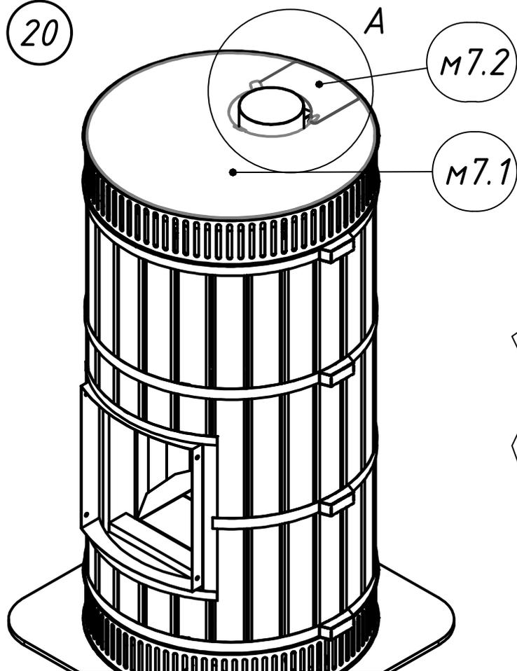
Установить детали верхней составной крышки м7: сначала разместить на верхнем фигурном обрамлении деталь 7.1, затем задвинуть выступы детали 7.2 под отогнутые ушки детали 7.1.
