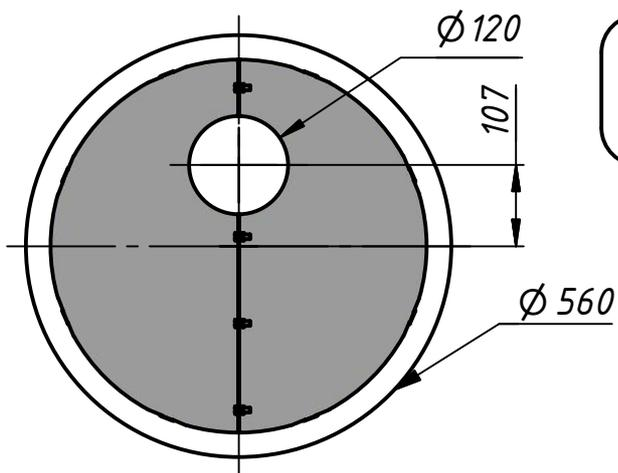
Разметку основания печи удобно произвести, положив на пол разъемную крышку мб.
