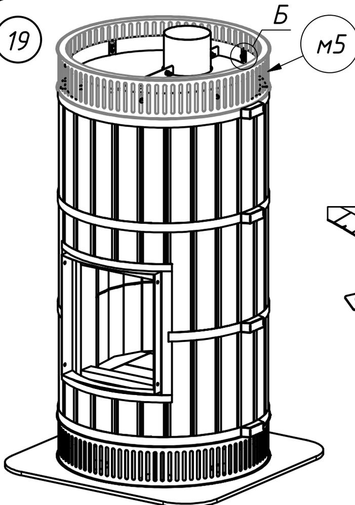
Ушки верхней фигурной окантовки м5 отогнуть вверх, как показано на схеме, затем закрепить данную деталь, а также крышку м6, на корпусе печи при помощи болтов к1 (8 шт.), плотно сжимая супервул крышкой.
