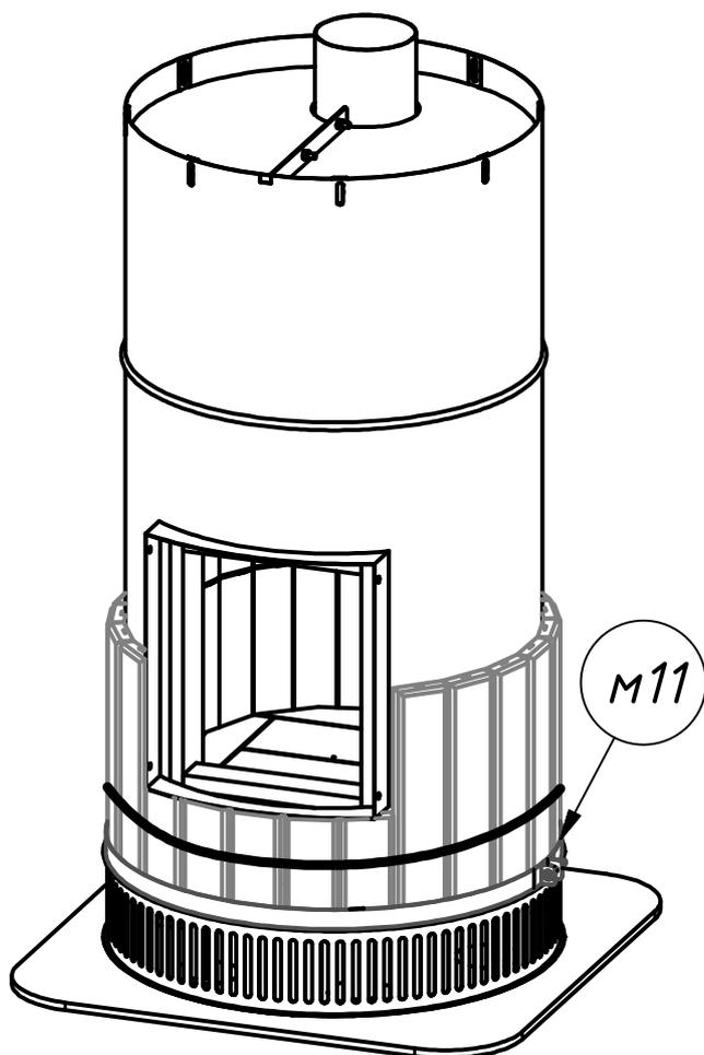
Далее собирается облицовка из плиток по рядам снизу вверх. Для начала работы на печь необходимо надеть эластичный жгут из комплекта. Затем, пользуясь схемой расположения элементов облицовки (см. стр. 10), расположить плитки первого ряда облицовки вокруг корпуса печи, подсовывая их под жгут. Первый ряд облицовки фиксируется нижним z-образным хомутом м11. Замок хомута рекомендуется располагать в "теневой" зоне.
