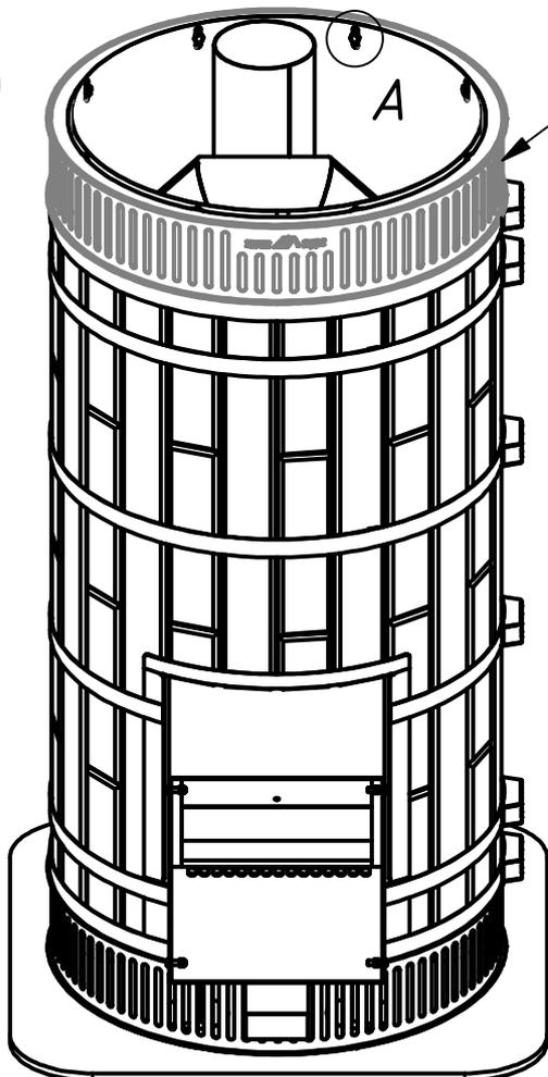
Ушки верхней фигурной окантовки M5 отогнуть вверх, как показано на схеме, затем закрепить данную деталь на корпусе печи при помощи болтов K2 (8 шт.).
