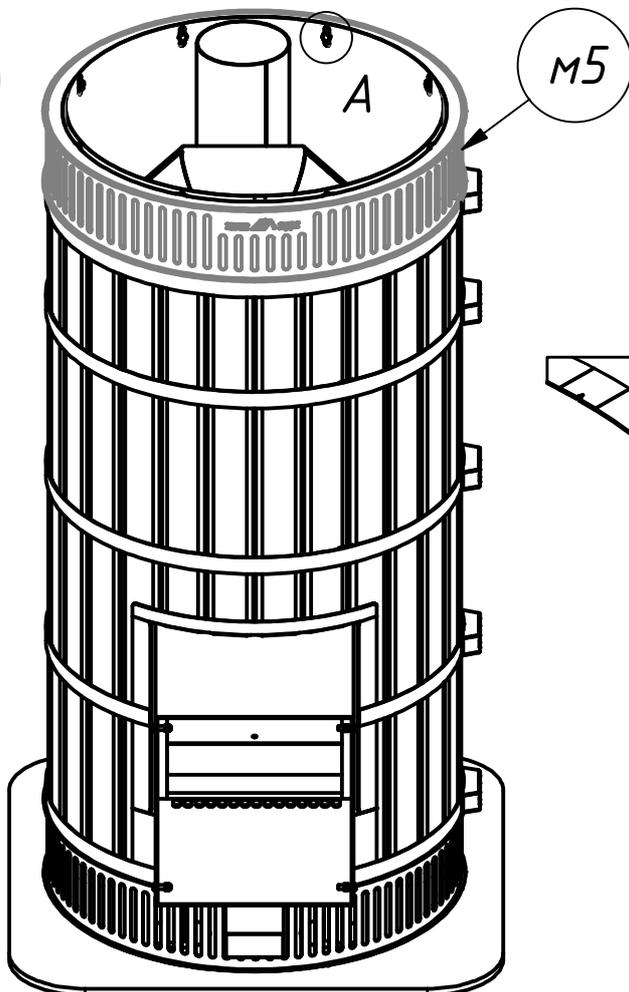
Ушки верхней фигурной окантовки M5 отогнуть вверх, как показано на схеме, затем закрепить данную деталь на корпусе печи при помощи болтов K2 (8 шт.).
