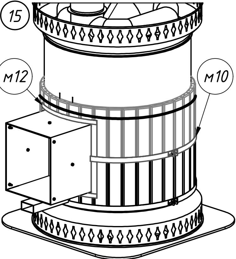
По мере сборки, эластичный жгут необходимо передвигать вверх для установки следующего ряда плиток облицовки, предварительно зафиксировав предыдущий ряд при помощи хомутов. Замки хомутов рекомендуется располагать друг над другом.
