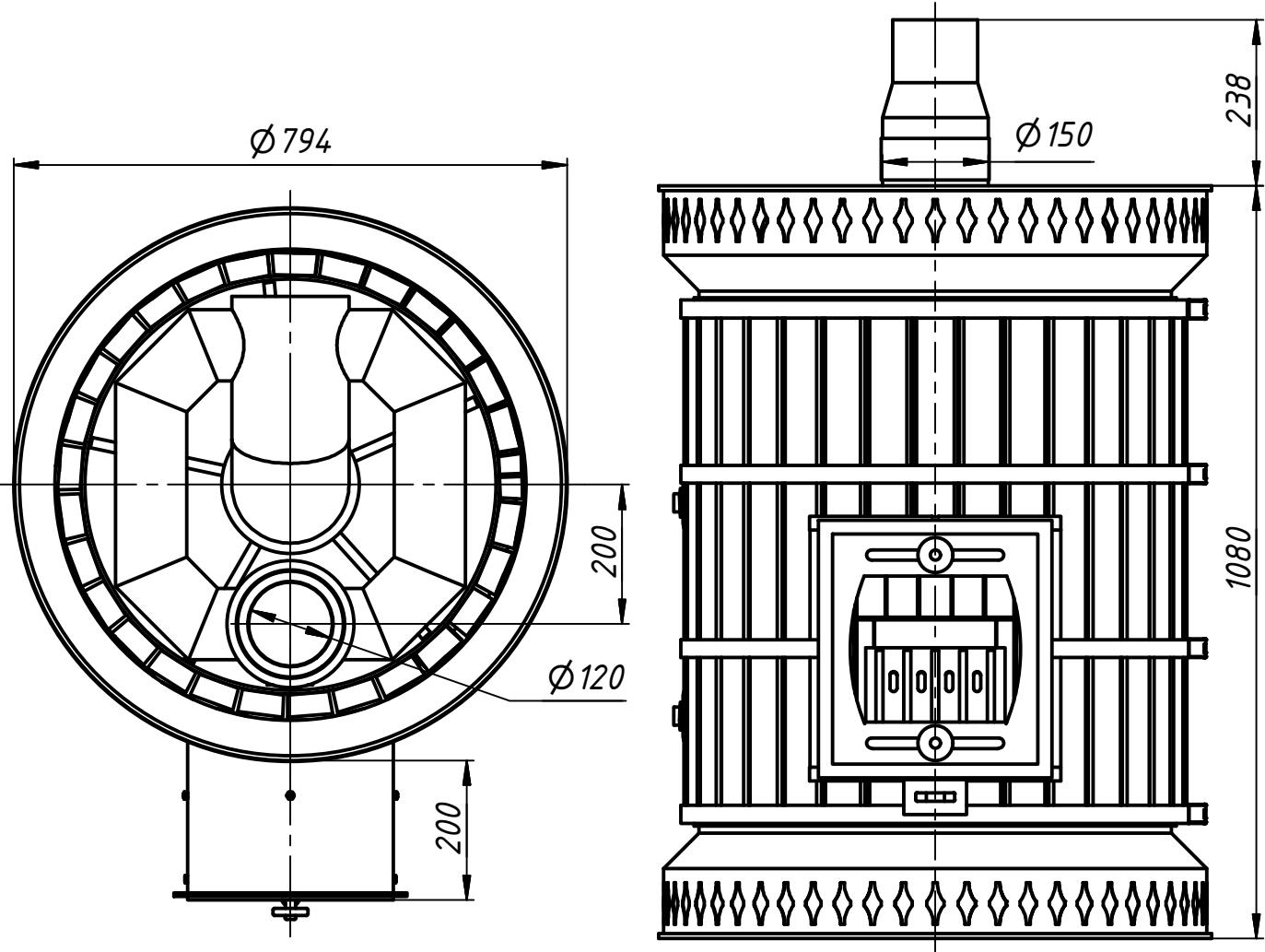
**ВНИМАНИЕ!** Сборку печи следует производить на негорючем ровном основании. Конструкции из сгораемых материалов обязательно должны быть защищены!
