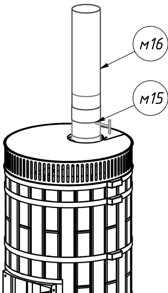
Установить заслонку м15, развернув ручку в удобную сторону, затем установить трубу м16.
