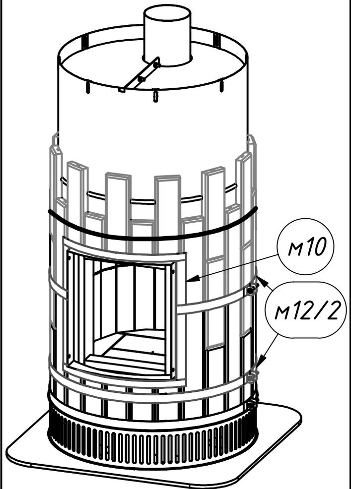
По мере сборки, эластичные жгуты необходимо передвигать вверх для установки следующего ряда плиток облицовки, предварительно зафиксировав предыдущий ряд при помощи хомутов.
