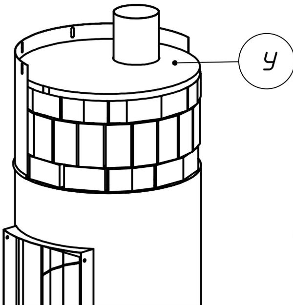
Вырезать из листа супервула толщиной 25 мм уплотнение У. Это удобно сделать, используя в качестве шаблона перевернутую крышку м6. Плотно уложить уплотнение на шмот внутрь детали м3.
