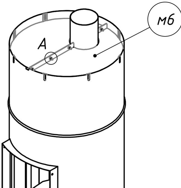
Установить крышку м6 в сборе, совмещая отверстия в ушках крышки с отверстиями в корпусе. Детали крышки должны быть плотно соединены между собой, как показано на схеме.
