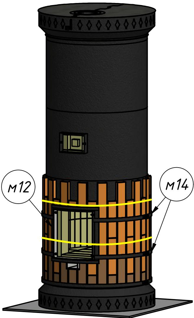
По мере сборки, эластичные жгуты необходимо передвигать вверх для установки следующего ряда плиток облицовки, предварительно зафиксировав предыдущий ряд при помощи хомутов.
