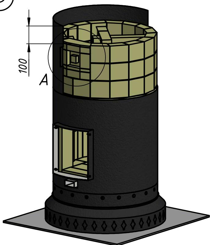
Детали чистки расположить таким образом, чтобы съёмный элемент №27 оказался напротив прочистного отверстия кожуха.
