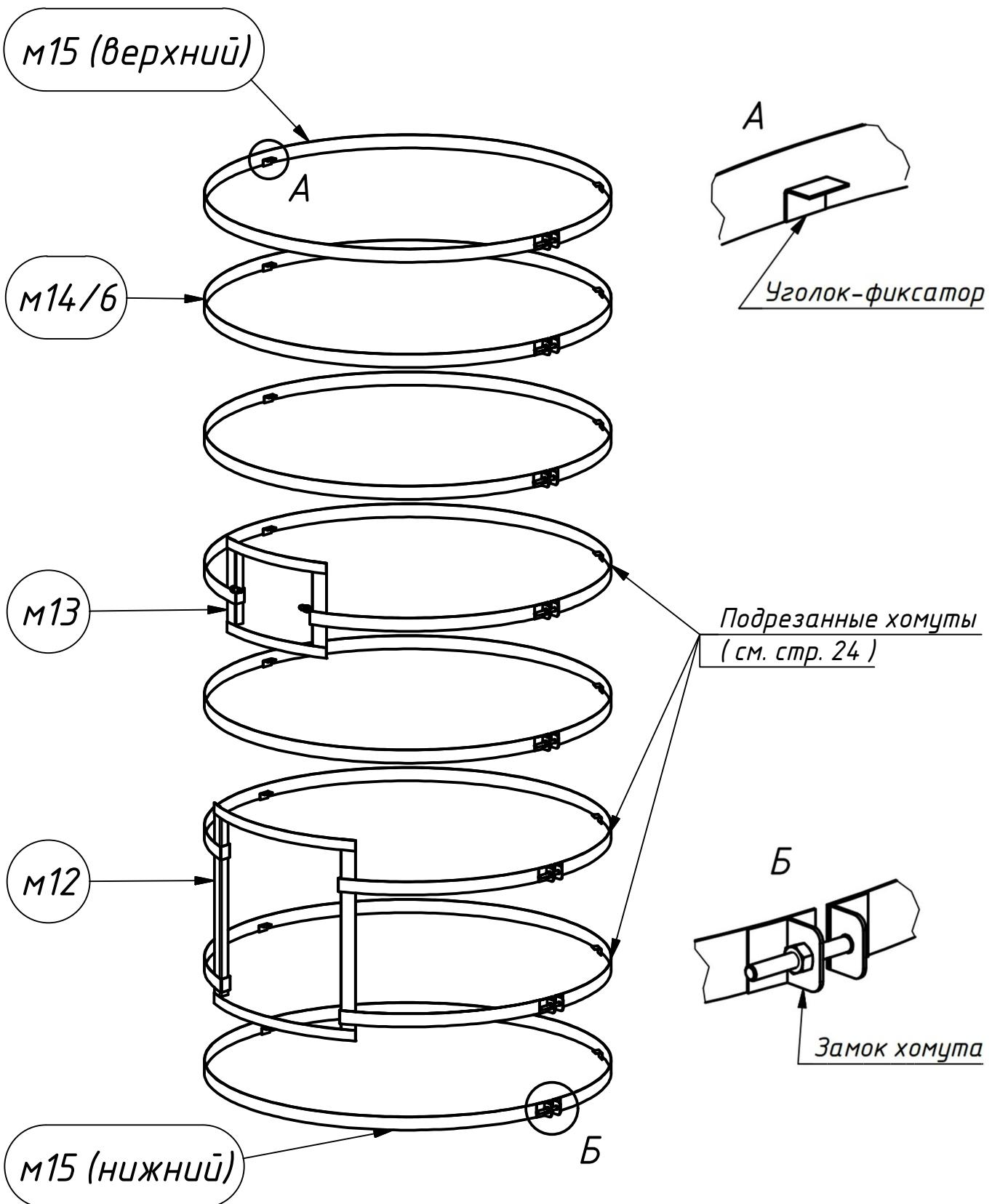
При размещении хомутов следить за тем, чтобы уголки-фиксаторы, расположенные на них, проходили между плитками облицовки и не препятствовали их размещению!
