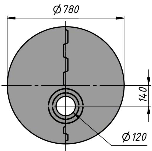
Разметку основания печи удобно произвести, положив на пол разъемную крышку мб.
