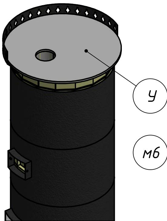
Вырезать из листа супервул толщиной 25 мм уплотнение У. Это удобно сделать, используя в качестве шаблона перевёрнутую крышку м6. Плотно уложить уплотнение на шамот внутрь детали м5.
