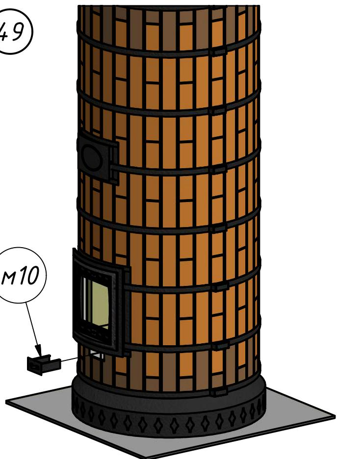
В заключение, установить на место регулятор притока м10 и, при необходимости, увеличить отверстие под дымоход в верхней крышке мб до нужного диаметра.
