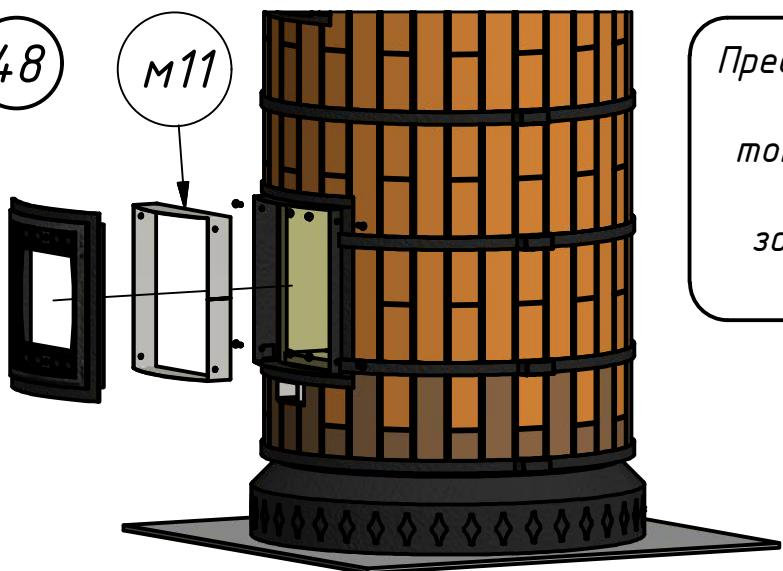
Предварительно открепив защиту тоннеля м11, установить топочную дверку м23 и, вместе с защитой тоннеля м11, закрепляем болтами к1 - 4 шт. и гайками к2 - 4 шт.
