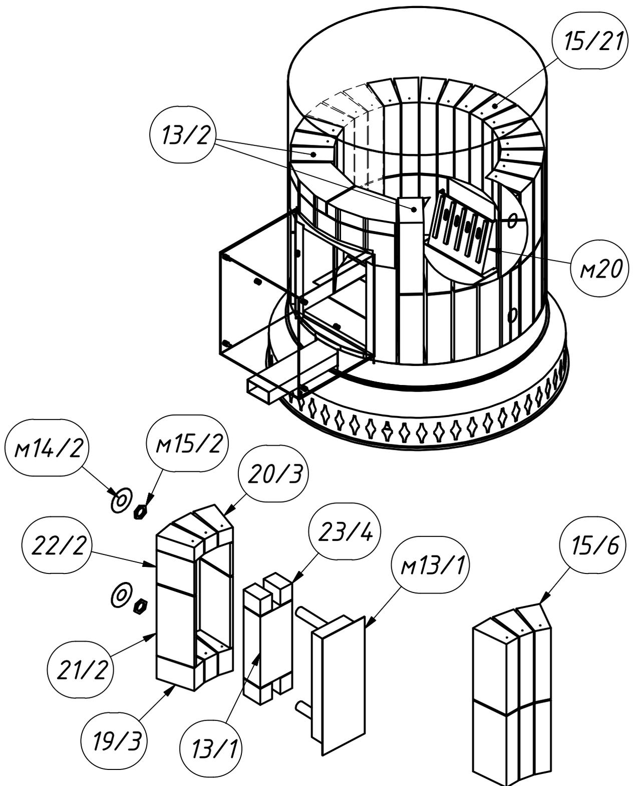
В случае комплектации с теплообменником, вместо шести кирпичей №15 устанавливаем блок теплообменника.
