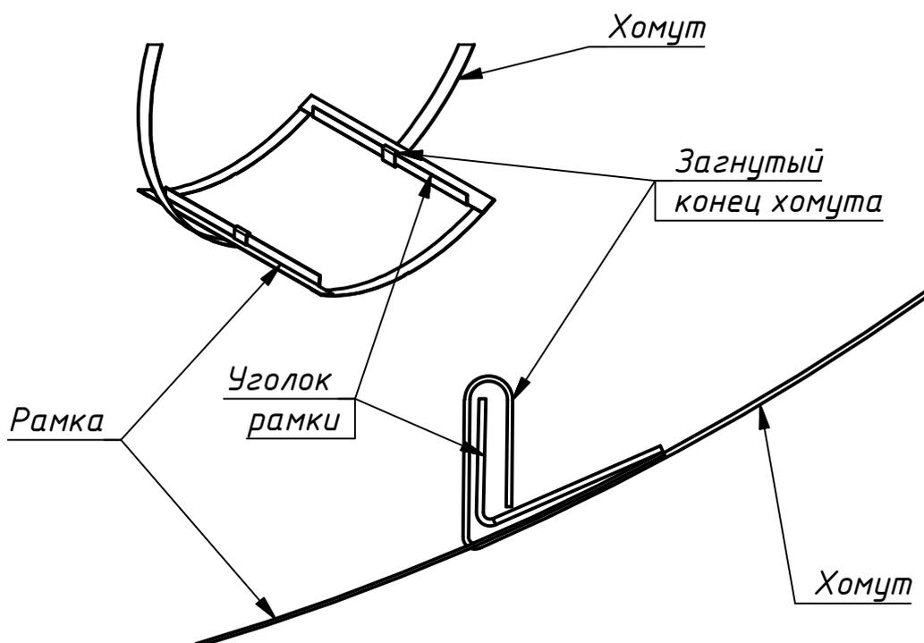
Надеваем хомут с рамкой на тоннель дверки ( дверку снять ) и затягиваем его, оставляя зазор для следующего ряда.
