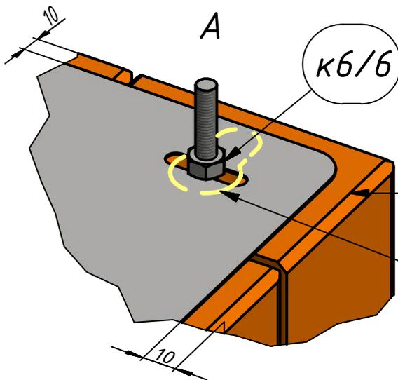
Расстояние между краями пластин и блоков около 10мм
