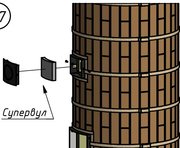
После сборки облицовки внутрь тоннеля прочностной дверки плотно вставить вырезанный с припуском прямоугольник из супервул, после чего установить заглушку чистки и закрепить ее болтами к1 – 2 шт.
