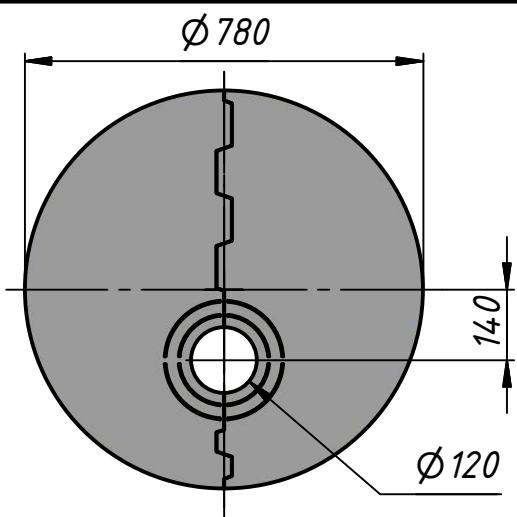
Разметку основания печи удобно произвести, положив на пол разъёмную крышку мб.
