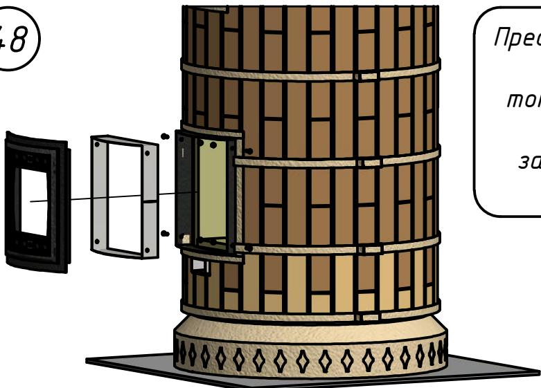
Предварительно открепив защиту тоннеля м11, установить топочную дверку м23 и, вместе с защитой тоннеля м11, закрепляем болтами к1 - 4 шт. и гайками к2 - 4 шт.
