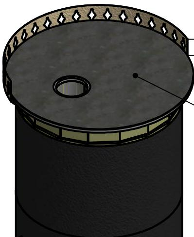
Уплотнитель **Ч** и рамку м26 прижать сверху деталью м16.
