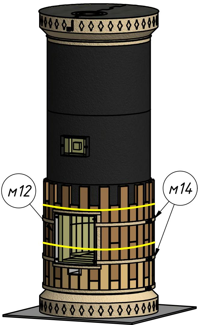
По мере сборки, эластичные жгуты необходимо передвигать вверх для установки следующего ряда плиток облицовки, предварительно зафиксировав предыдущий ряд при помощи хомутов. Замки хомутов рекомендуется располагать друг над другом. На данном шаге следует насадить рамку M12 вместе с двумя хомутами M14, сильно не затягивая их, чтобы иметь возможность подкладывать плитки облицовки под хомуты.
