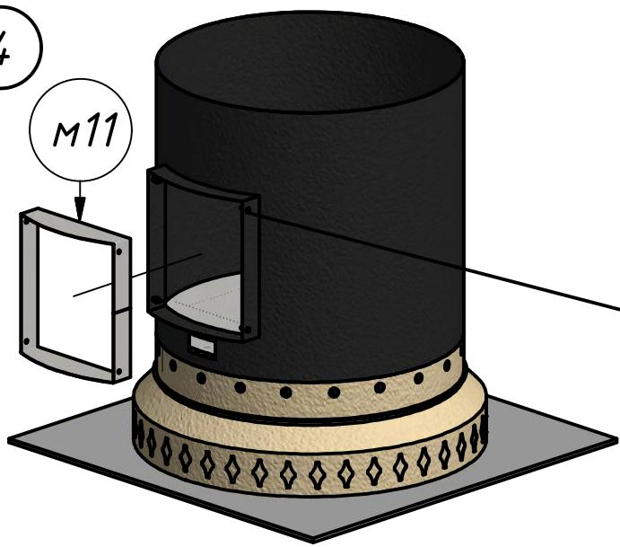
Зашиту тоннеля м11 временно закрепить в тоннеле при помощи болтов K1 - 4 шт. и гаек K2 - 4 шт.
