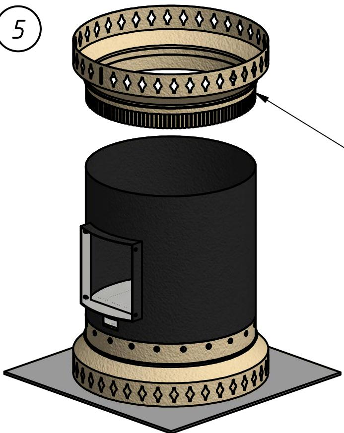
Для соблюдения круглой формы, при заполнении кожуха шамотом временно надевать верхнее фигурное обрамление корпуса м5.
