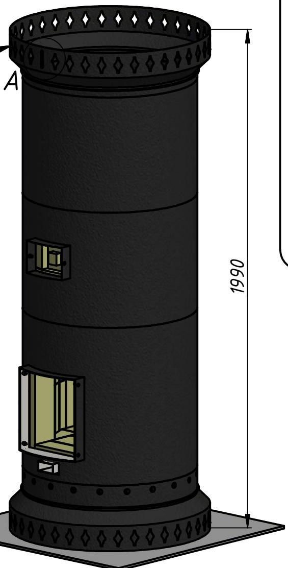
Верхнюю корону м5 расположить таким образом, чтобы овальный вырез под шток шибера был направлен в нужную Вам сторону. (не обязательно так, как на схеме) Временно установите деталь м16 как на листе 19 и проверьте, помещается ли шибер м18 в верхнее фигурное обрамление м5 в выбранном положении. Если нет – поверните деталь м5 таким образом, чтобы все детали помещались на свои места.
