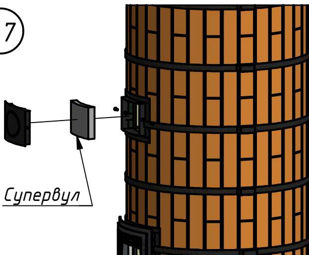
После сборки облицовки внутрь тоннеля прочностной дверки плотно вставить вырезанный с припуском прямоугольник из супервула, после чего установить заглушку чистки и закрепить ее болтами  $k1$  – 2 шт.
